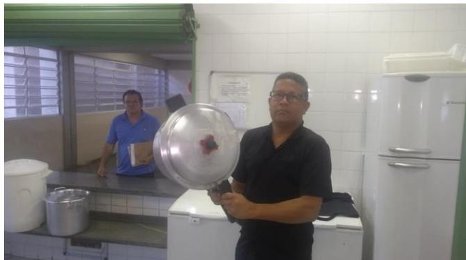
As cozinheiras estão utilizando painéis de Pressão com a válvula de segurança rebitada, causando sérios riscos de explosão e queimaduras.
